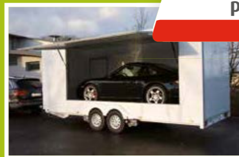
Hayon relevable avec 2 vérins à gaz et fermetures à clé
