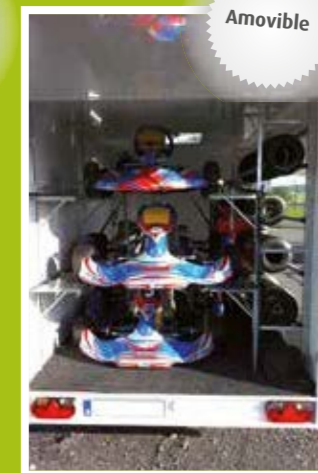
Etage support kart et rack à pneus
