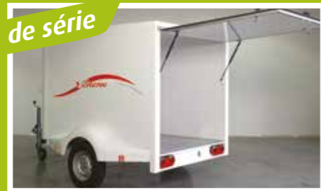
Hayon relevable avec 2 vérins à gaz et fermetures à clé
