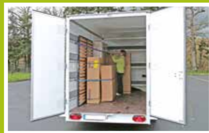
2 Portes arrière ouverture 270° avec fermeture crémone à clé en inox
