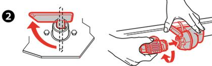
Si présent : Mettre sous tension l'interrupteur coupe-batterie ; enfoncer la fiche dans la prise de courant de sécurité
