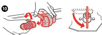
Retirer la fiche hors de la prise de courant de sécurité et la brancher sur la prise du véhicule tracteur ; si un interrupteur coupe-batterie est présent, le mettre hors tension
