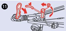
Pour poursuivre le trajet : atteler au véhicule tracteur ; relever la roue avant avec la manivelle ; desserrer le frein à main
