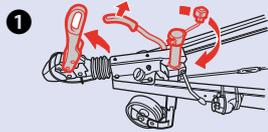
**Condition :** Frein de parcage serré ; roue avant descendue ; véhicule tracteur dételé
