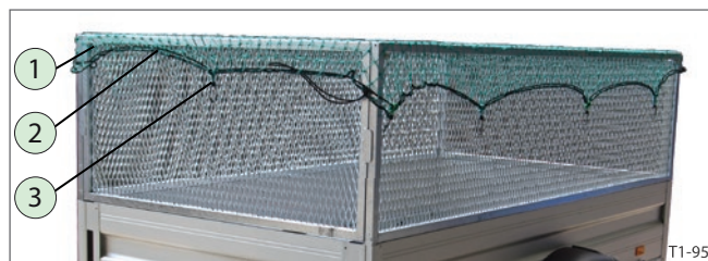
Filet de couverture installé au-dessus de la superstructure grillagée
