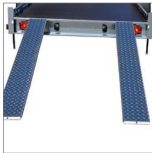
Rampes / rails de chargement
