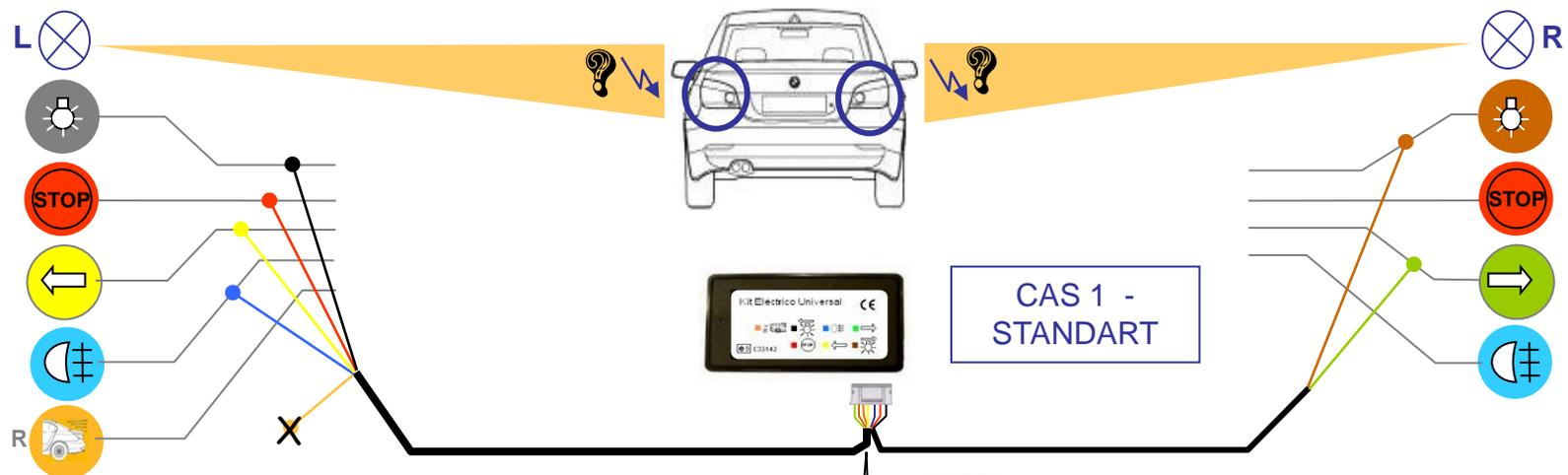
Tester les fonctions véhicule et connecter selon les couleurs indiquées (étiquette du module) sur les câbles des feux arrière. Pour les système multiplexés consulter pag. 3.
