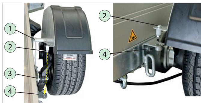
Mécanisme d'abaissement / amortisseurs de roue
