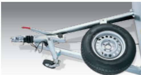
Support de roue de secours monté sur timon (uniquement avec timon de traction long)
