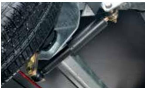
Amortisseurs (montés) y compris activation de 100 km/h
