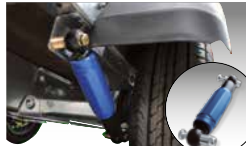
Amortisseur (monté) y compris activation de 100 km/h Amortisseur (non monté) sans activation de 100 km/h
