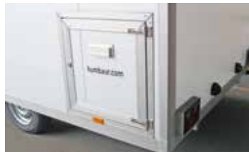
Armoire des bouteilles à gaz avec accès extérieur
