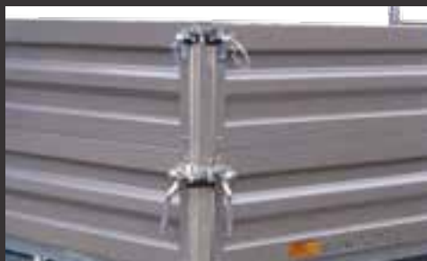
Rehausse de ridelle en acier de 350 mm
