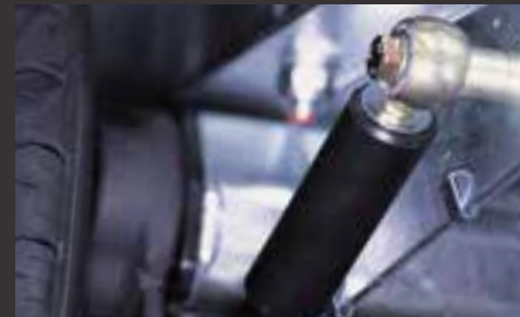
Amortisseurs de chocs (montés) avec activation à 100 km/h
