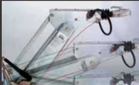
Timon réglable en hauteur (dispositif d'attelage à tête sphérique et anneau d'attelage DIN non compris)
